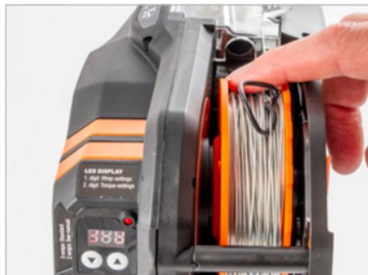
2. Drahtrolle einlegen. Den Draht lösen und das Gummiband entfernen.
