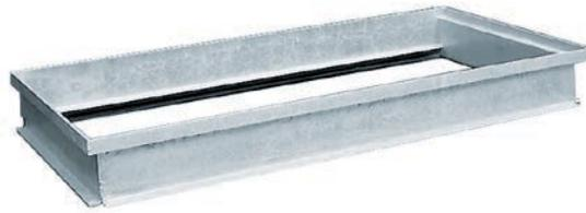
Zur exakten Höhenanpassung des Gitterrostes an die Belagoberfläche. Betonrandfreier Belaganschluss bis an die Zarge. Breiten: 50 und 60 cm, Nutzhöhen: 5 cm, 7,5 cm und 10 cm. Für alle Standardroste MW 30/30, MW 30/10, MW 20/20. Nicht alle Größen lagerhaltig, Lieferzeit 2 - 3 Wochen.
